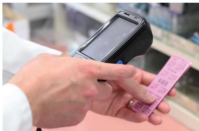
▲ピッキング時にハンディターミナルで 薬剤バーコードを読み込む
