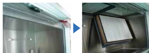
①ワークエリア上部のグリルを外す。 ②HEPAフィルターの固定ボルトを外して、フィルター交換
