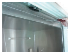
①ワークエリア上部のグリルを外す。 ②HEPAフィルターの固定ボルトを外して、フィルター交換
