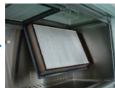
①ワークエリア上部のグリルを外す。 ②HEPAフィルターの固定ボルトを外して、フィルター交換
